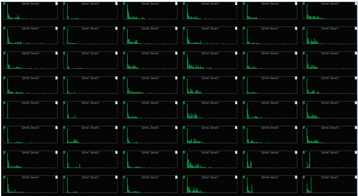
Figure D-6. Exemple de bruit asynchrone affichant une distribution faussée.
