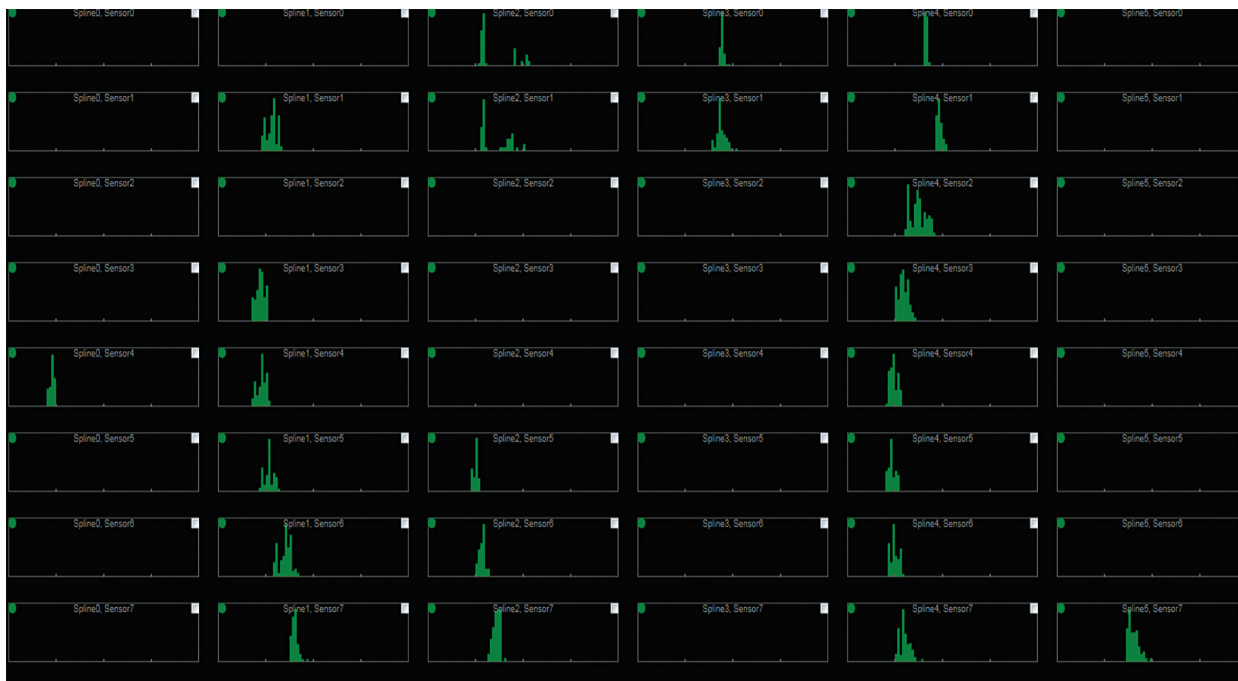
Figur D-3. Exempel på en helt fungerande uppsättning ultraljudsomvandlare i en statisk in vivo -position.
