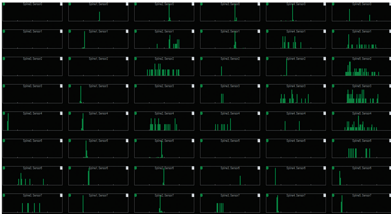
Figur D-5. Eksempel på flere knudepunkter med registrerede områdefordelinger, som strækker sig ud over en rimelig udsvingsafstand.
