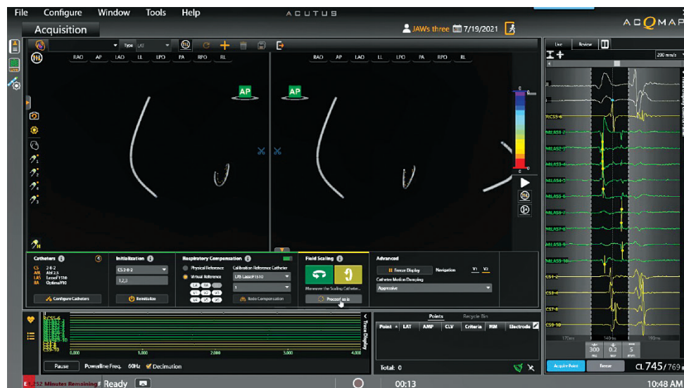
Figura 16-5. Mueva el catéter en las direcciones horizontal y vertical hasta que las flechas horizontal y vertical se tornen verdes.
