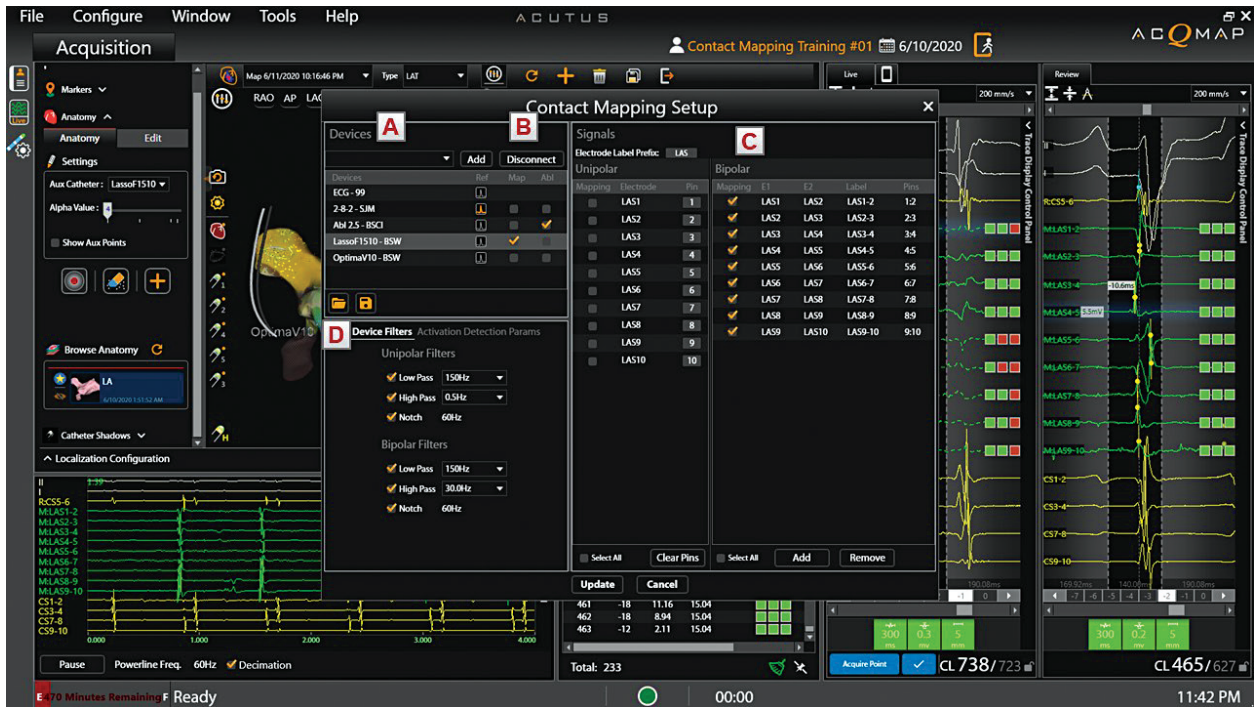
Figura 16-1. Configuración para cartografía con contacto; definición de catéteres. A. Panel Devices (Dispositivos). B. Definir la función del catéter. C. Asignar canales unipolares y bipolares. D. Configurar parámetros de filtros y detección.
